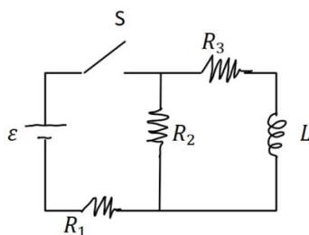
במעגל הבא מתקיים:  $\varepsilon = 5V, R_1 = 100\Omega, R_2 = 200\Omega, R_3 = 300\Omega, L = 30mH$
