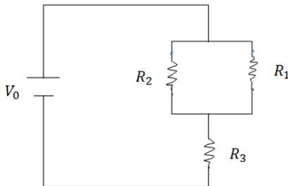
במעגל הבא נתונים ההתנגדות של כל נגד ומתח המקור:  $R_1 = 2\Omega$ ,  $R_2 = 3\Omega$ ,  $R_3 = 5\Omega$ ,  $V_0 = 31V$ .
